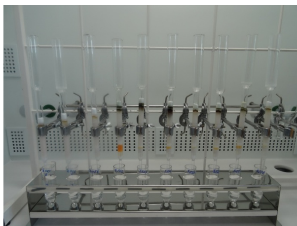
Obr. 10: Sloupcová chromatografie s použitím aktivního sorbentu.
