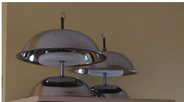
Obr. 5: Pasivní vzorkovač s PUF diskem, instalace ve vnitřním prostředí, pro které je doporučena otevřená varianta (odkrytá spodní nerezová miska; horní miska zabraňuje gravitačnímu usazování prachových částic na povrchu PUF disku).
