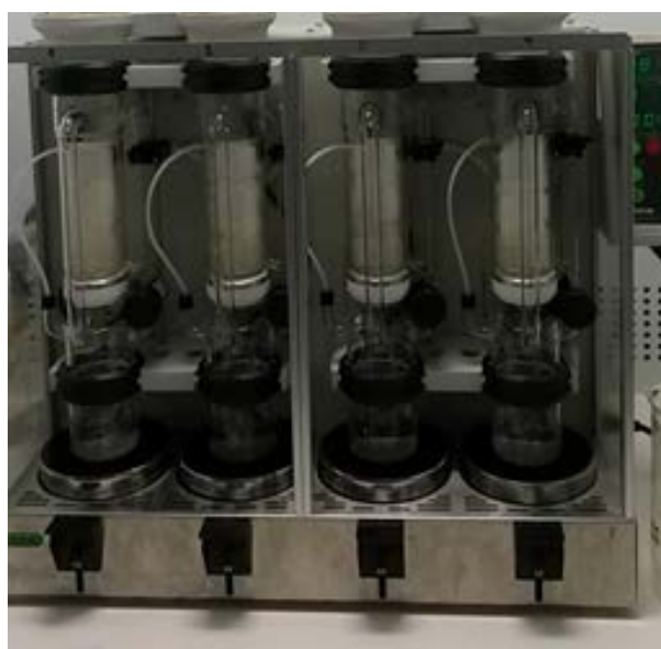
Obr. 9: Automatický extrakční systém Büchi B-811.
