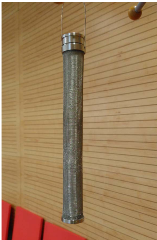
Obr. 7: XAD vzorkovač pro vzorkování PFCs.
