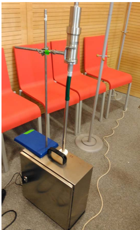
Obr. 2: Nízkoobjemový aktivní vzorkovač.
